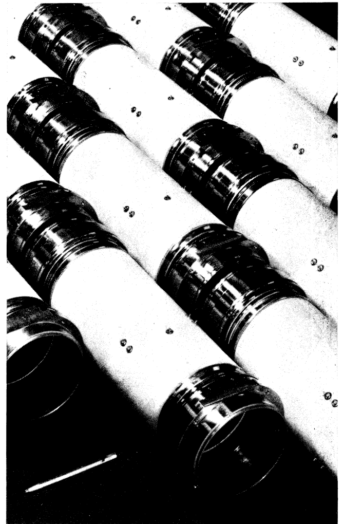
Electrodes Pick-up réalisées pour le Booster Service SI. - Métallisation intérieure, avec dorure. Scellement étanche céramique-titane-inox, et assemblage des embouts inox sur inox par bombardement électronique.
